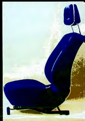
Asiento de seguridad, con sistema "antisubmarino" que impide que el ocupante se pueda desplazar hacia abajo.
